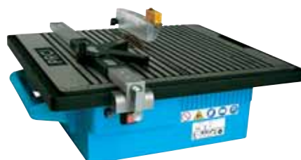
Coupe-carreaux rainuré T180 750 W. Plateau en fonte d'aluminium très rigide. Demi-plateau inclinable à 15°, 30° et 45°. Ø du disque 180 mm. Hauteur de coupe max. à 90° : 34 mm ; à 45° : 24 mm. Plateau strié et rainuré pour la récupération de l'eau. Réf. 663 614 42 185,00€
