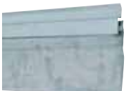
Solins avec bavettes •2 Ils assurent un raccord étanche entre un toit incliné et un mur. Ce type de solin, présenté par longueur de 2 m, est pourvu d'une bavette métallique souple, en plomb brut ou en aluminium coloré. Un joint mastic est nécessaire à l'assemblage.
