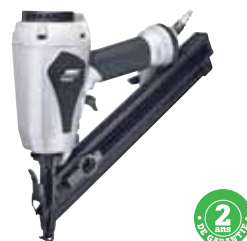
Cloueur PN 32-65 Encadrement, pose de panneaux, assemblage, parquet, charpente, linteaux. Clous 30 de 32 à 64 mm. Pression d'utilisation 5-8 bars. Distance d'agrafage contre une cloison : 2,5 mm. Réf. 665 815 15 300,00€
