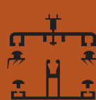
Profil T : porteur jusqu'à 1 m
