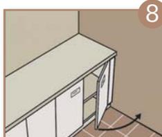
8 Laissez un espace entre le mur et le dernier élément, bas ou haut, pour ouvrir plus facilement les portes. Cet espace sera comblé par un profil de compensation ou fileur.
